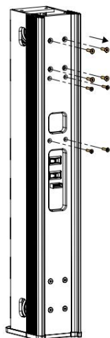
Schritt 5: Lösen Sie die 8 hinteren Schrauben. Die Blindplatte ist lose, halten Sie sie fest
